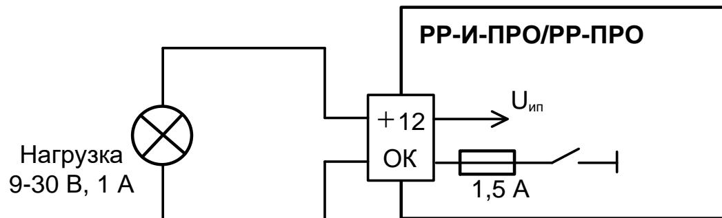
Схема подключения силовых выходов типа "Открытый коллектор" с внешним источником питания постоянного или переменного тока.
