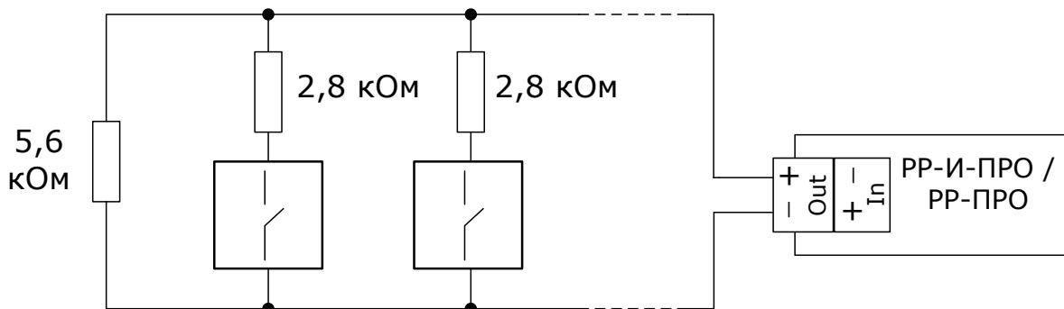
Подключение **нормально замкнутых пожарных** извещателей с выходом типа "сухой контакт":
