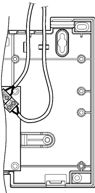
После навешивания контроллера он закрепляется на стене путём ввёртывания одного, либо двух дополнительных шурупов.
