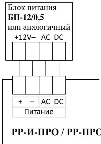
Для питания контроллеров возможно использование резервированного блока питания "БП-12/0,5" производства "Аргус-Спектр" с несущей панелью, позволяющей закрепить прибор непосредственно на блоке питания и выполнить все соединения внутри корпуса.
