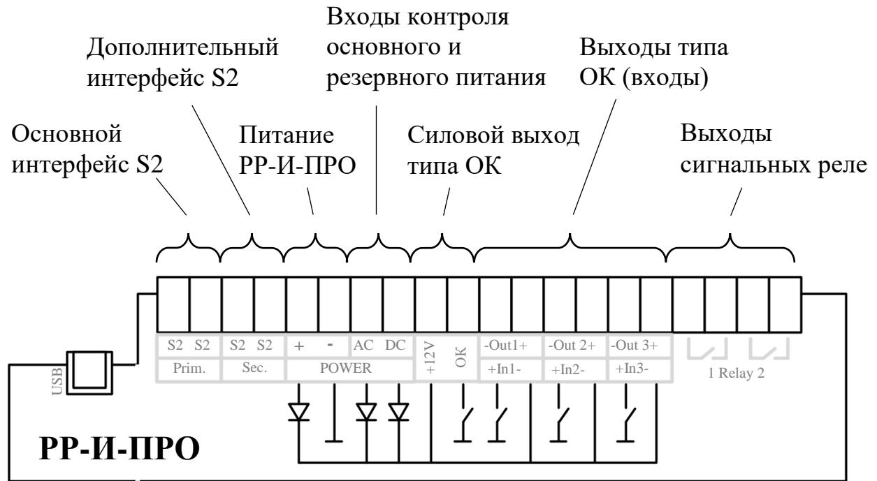
*Примечание: на рисунке показана внутренняя структура в случае конфигурирования выходов 1, 2, 3 в качестве **выходов***
