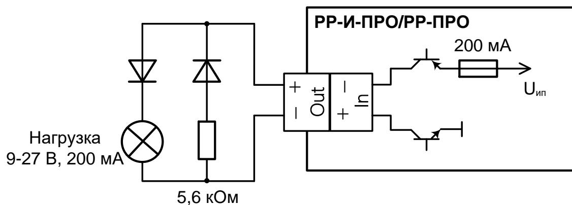
Схема подключения силовых выходов типа "Открытый коллектор".
